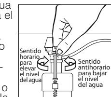
**Nota importante:** En la descarga, sólo se transfiere a la taza una parte del agua del tanque. Esto es normal en un inodoro de bajo consumo. Terminada la descarga, el tanque tendrá un remanente de aproximadamente 5-5 1/2 pulg. de agua.
