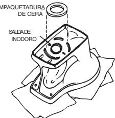
2. Ponga cuidadosamente el inodoro boca abajo sobre una pila gruesa de periódicos o un trapo para proteger el acabado. Coloque una junta de cera nueva en la salida del inodoro. Puede aplicar un cordón de compuesto fijador a la base/pie si lo desea.
